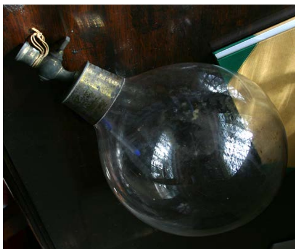
Εικόνα 5: Κοίλη γυάλινη σφαίρα για τον υπολογισμό της πυκνότητας αερίων
